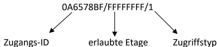
Der linke Teil der Benutzererkennung „0A6578BF“ beinhaltet die eindeutige Zugangs-ID des Benutzers. Der mittlere Wert beinhaltet die Etagen, die der jeweilige Besitzer der Schlüsselkarte anfahren darf. Jede Etage wird durch ein Bit für anfahren erlaubt (,1') oder anfahren nicht erlaubt (,0') dargestellt. Der Zugriffstyp beschreibt wie der Zugriff auf die Etagen des Aufzugs zu handhaben ist.
