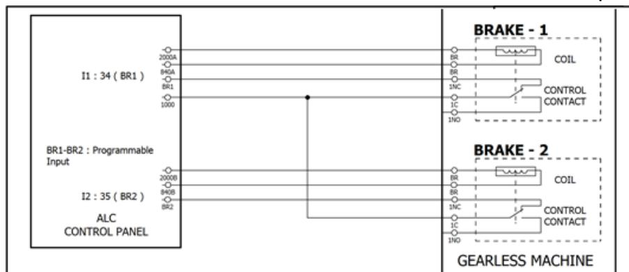
Abbildung 7-2 Schaltbild für UCM bei Traktionsaufzügen mit Synchronmotor
