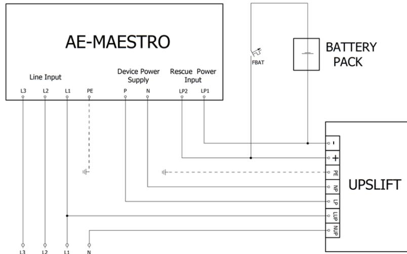
Abbildung 8-1 Schaltbild für Evakuierungssystem des Typs J
