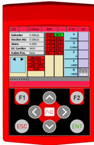
Das Handterminal des AE-MAESTRO kann entweder im Gerät oder an einer beliebigen Stelle innerhalb des Schachtes verwendet werden, solange ein Anschluss an die Spannungsversorgung und den CAN-Bus zur Verfügung steht. Dieses Gerät ist optional und verfügt über einen SD-Karten-Slot. Es dient zur Verwaltung des Geräts, sowie zum Aufspielen von Updates und Übertragung von Einstellungsparametern. Die Fahrkurven des Aufzuges können auf dem Gerät angezeigt und gespeichert werden.
