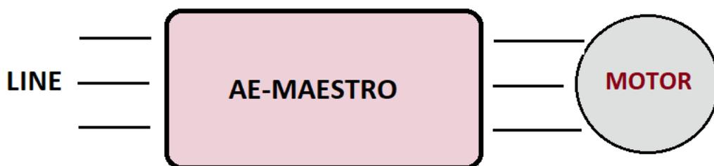
Abbildung 1-2 Schützloser Betrieb des AE-MAESTRO (STO)
