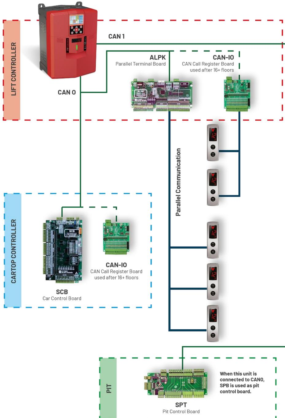
Abbildung 2-4 Verbindungen und Platinen bei paralleler Kommunikation.
