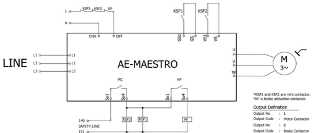
Abbildung 3-1 STO Anschluss mit Kleinschütz oder Sicherheitsrelais
