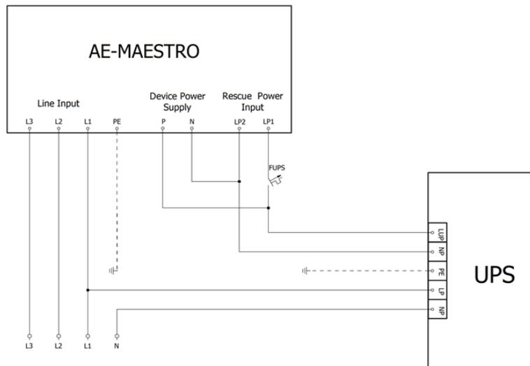
Abbildung 8-2 Schaltbild für Evakuierungssystem des Typs N
