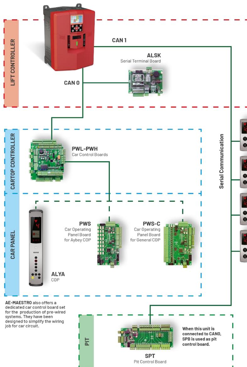
Abbildung 2-3 Verbindungen und Platinen bei vorverdrahtetem System.
