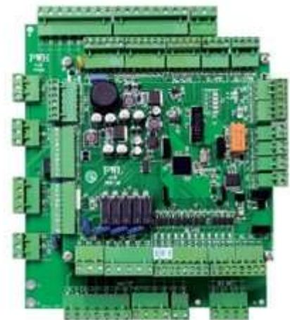
7. Die 4 Steckverbinder der 24-adrigen Hängeleitung sind in die Steckbuchsen XH-HV3, XH-HV2 und XH-HV1 der PWL Platine und XL-LV2 der PWH Platine in der Wartungssteuerung zu stecken.
